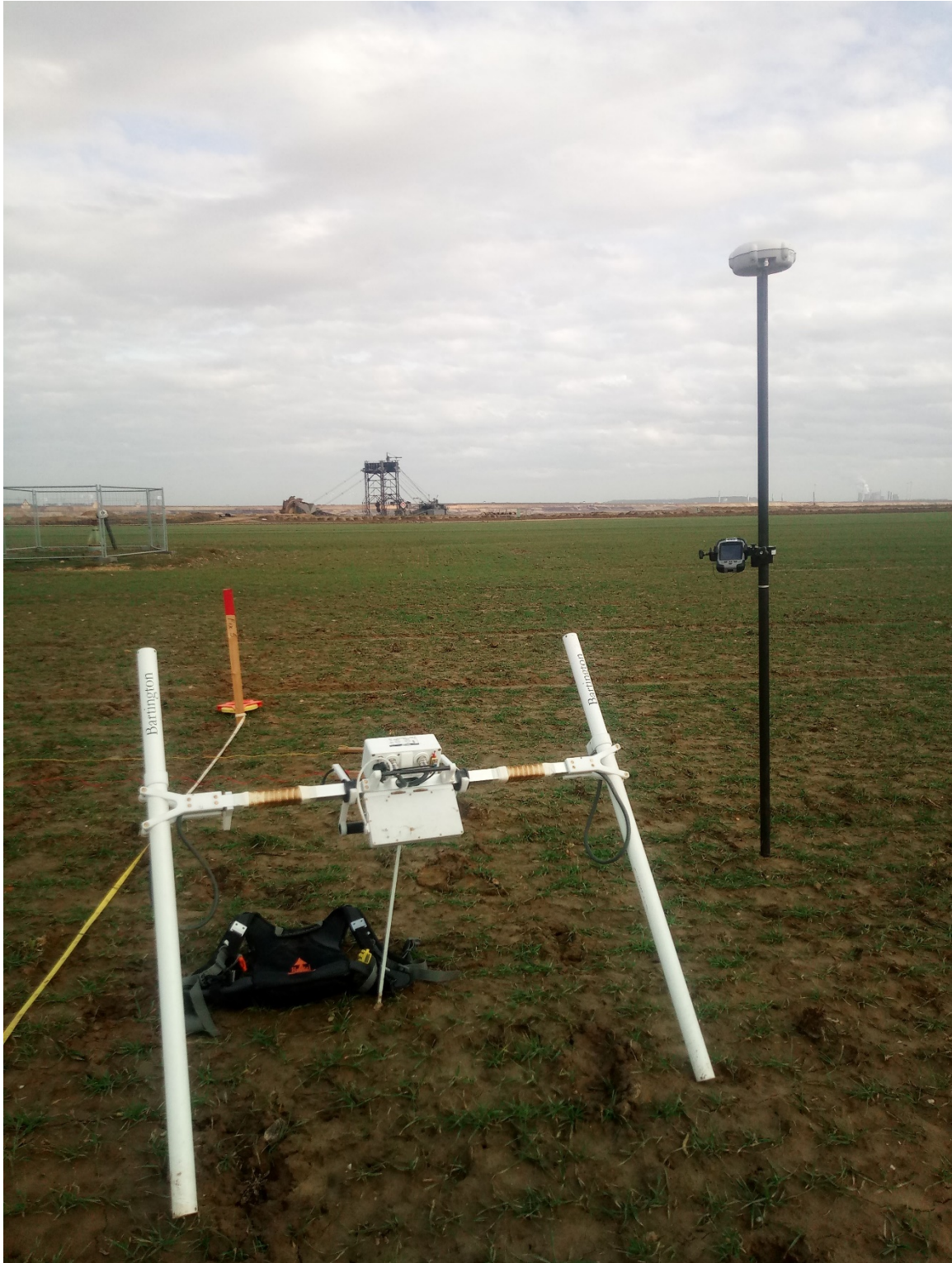
Abbildung 1: Feldprospektion. Das Magnetometer und das GPS-Gerät im Tagebau Garzweiler II mit dem Schaufelradbagger im Hintergrund. (Foto: Anna-Lena Roeder)
